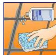
Mouiller les résidus de ciment avec du produit non dilué et retirer avec un pad blanc.
