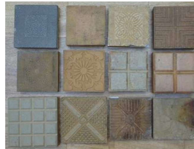
Plavuizen met anti-slippatronen in diverse maten en kleuren van diverse oorsprong (studiecollectie M. Baeck)
